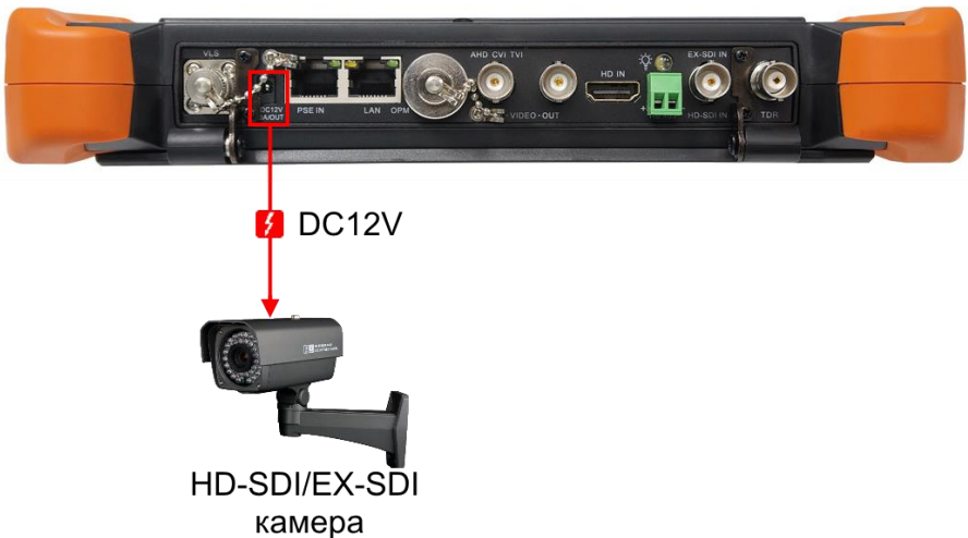
Рис. 13 Подключение питания к видеокамере HD-SDI или EX-SDI
