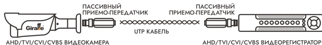
Рис. 1 Схема включения пассивного приемопередатчика.
