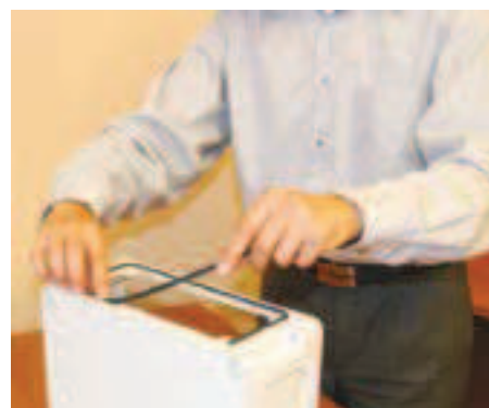
3. Установите уплотнитель на оба объединяемых корпуса
