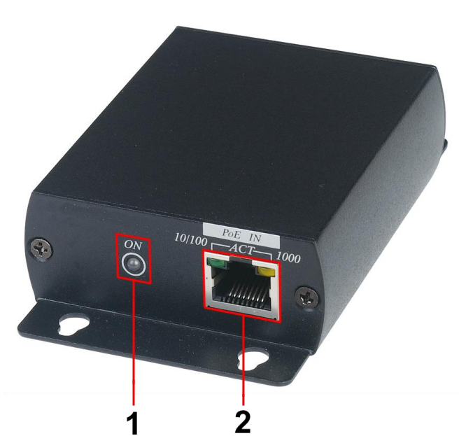
Рис. 2 IP04R, разъемы и индикаторы на передней панели
