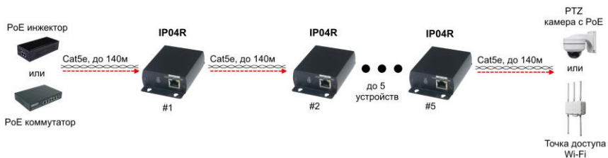
Рис.5 Типовая схема подключения удлинителя IP04R при каскадном подключении
