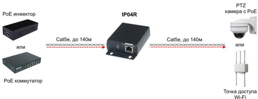
Рис.4 Типовая схема подключения удлинителя IP04R
